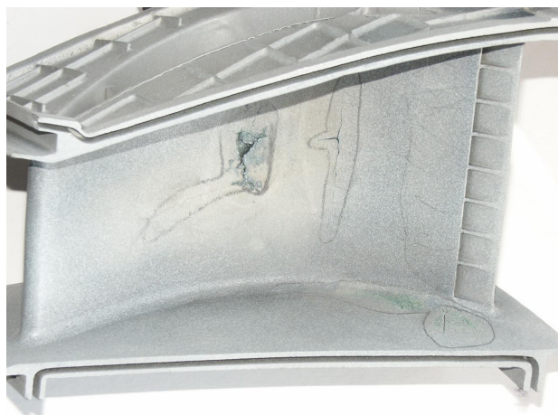
Рис. 1. Внешний вид поврежденной лопатки
