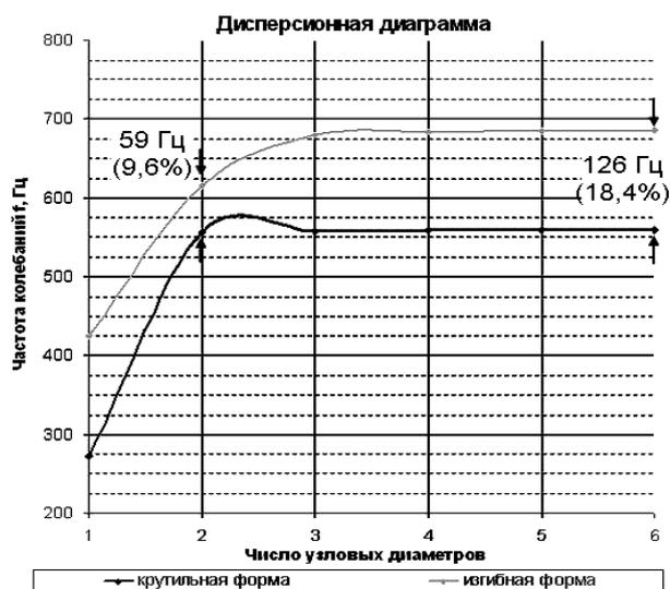
Рис. 8. Частотная диаграмма собственных форм колебаний РК1
