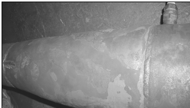
Рис. 12. Окалина на стенках камеры сгорания ПуВРД
