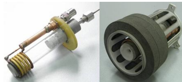
Рис. 2. Фотографии инженерных моделей: 01 без корпуса слева; 02 с корпусом и постоянными магнитами справа
