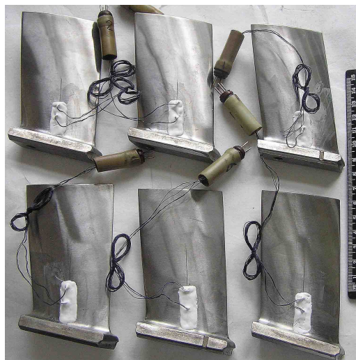
Рис. 1. Образцы для определения ООН в профильной части пера лопаток
