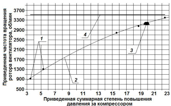
Рис. 5. Дроссельная характеристика по данным ПСИ вида n_{В пр} = f(\pi_{\Sigma пр}) : 1 – данные ПСИ; 2 – дроссельная характеристика; 3 – точки на контрольном участке; 4 – ограничение по данным ПСИ
