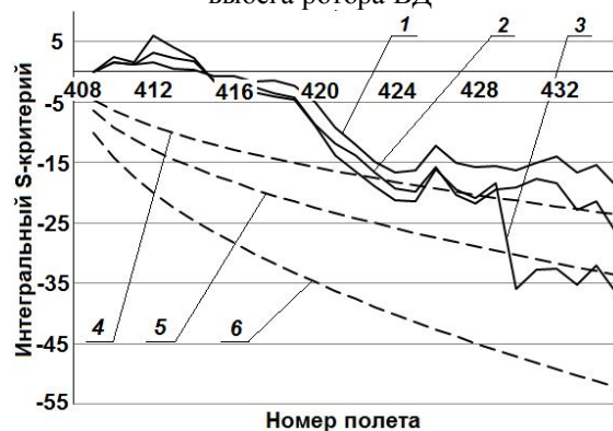
Рис. 9. Анализ трендов выбегов роторов:
