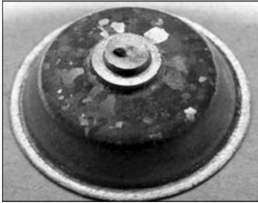
Рис. 6. Смещение ионного кратера относительно центра катода
