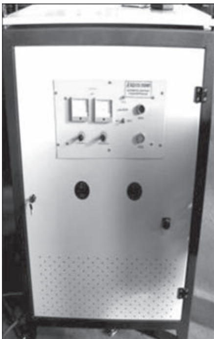
Рис. 4. Источник сварочного тока для работы с удаленными объектами
