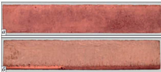
Рис. 5. Формування металу шва в продольному перетині по вісі з міді марки М1 довжиною 100 мм при ЕПЗ у нижньому положенні по стику ( \times 1,5 ): a – без проставки; б – з проставкою з ВТ1-00 товщиною \delta = 0,05 мм. Режим ЕПЗ: U_{\text{приск.}} = 60 кВ, I_{\text{п}} = 197 мА; v_{\text{зв}} = 7,5 мм/с; +\Delta I_{\phi} = 5 мА; l_{\text{роб}} = 200 мм; D = 1,5 мм
