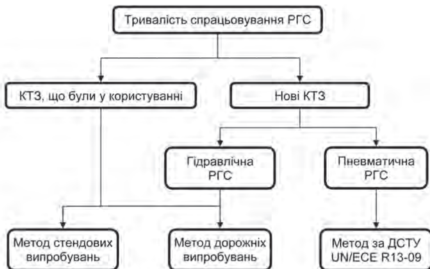
Рис. 1. Застосування методів визначення тривалості спрацьовування РГС
