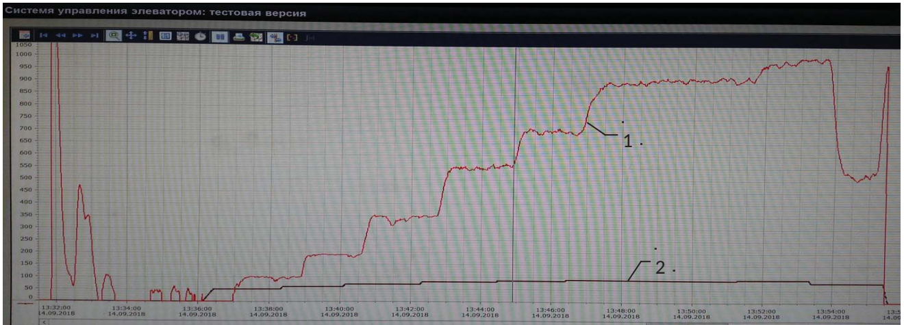
Рис. 1 – Вид окна с диаграммами изменения производительности 1 (т/ч) ПТЛ отгрузки зерна в судно и степени открытия подсилосной задвижки 2 (%) при проведении активного эксперимента по снятию расходной характеристики подсилосной задвижки
