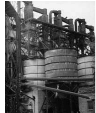
Осаждение и хранение вспученного перлита
