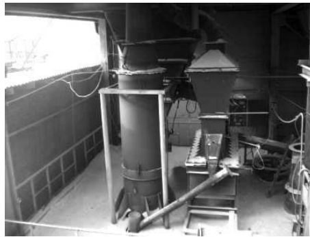
Предварительная термопод-готовка в печи термопод-готовки кипящего слоя и вспучивание в шахтной печи
