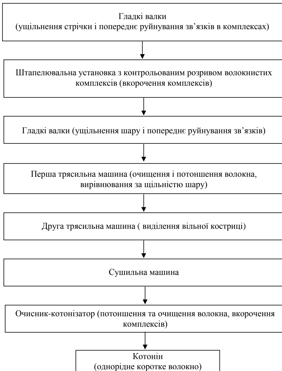
Рис. 2. Технологія отримання короткого льняного волокна.
