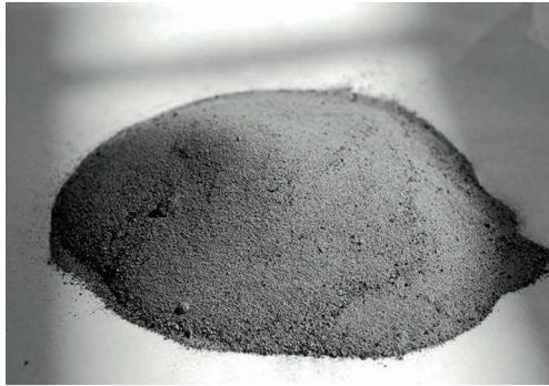
Рисунок 5 — Зразок золи-винесення, підготовлений до випробування
