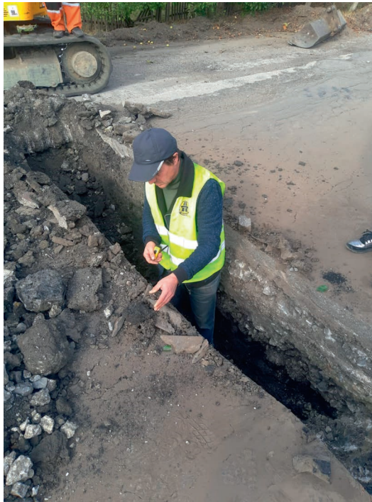
Рисунок 5 — Дослідження у шурфу матеріалів існуючого дорожнього одягу
