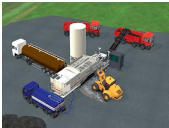
Рисунок 2 — Виготовлення органо-мінеральної суміші із фрезерованої крихти на стаціонарному змішувачі
