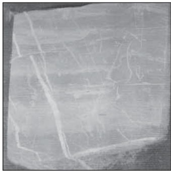
Рис. 2. Субвертикальні та горизонтальні тріщини в графтітових аргілітах, що заліковані кальцитом з утворенням прожилково-вкрапленої мінералізації у керні за розрізом параметричної свердловини Ліщинська-1:
