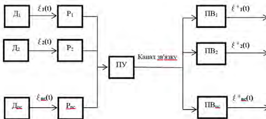
Рисунок 2 – Структура багатоканальної адаптивної системи
