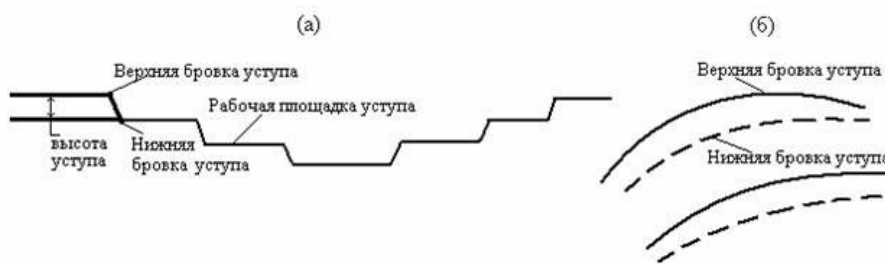
Рис. 1. К моделированию поверхности карьера:
