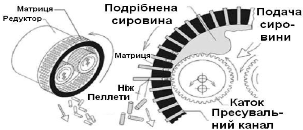
Рис. 2. Принцип роботи прес-гранулятора з круглою матрицею
