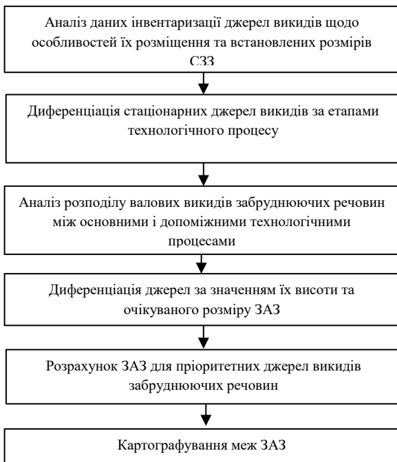
Рисунок 8 – Конкретизована блок-схема послідовності дій із визначення ЗАЗ для підприємств Північного промвузла м. Кременчук
