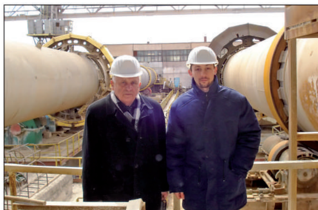
Рисунок 3 – Вращающиеся печи Ватутинского комбината огнеупоров, переведенные на сжигание шелухи подсолнечника (слева – руководитель разработки И.Н. Карп, академик НАН Украины)
