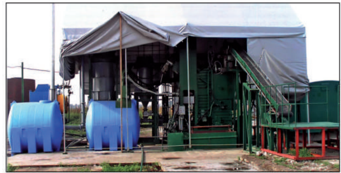
Рисунок 4 – Технологический комплекс для термического обезвреживания токсичных отходов
