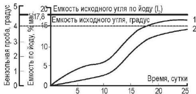
Рисунок 2 – Влияние продолжительности обработки на степень биологической регенерации угля КАД-йодный по йоду (1) и по бензольной пробе (2)
