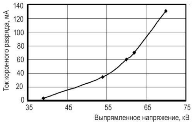
Рисунок 10 – Вольт-амперная характеристика третьего поля электрофильтра № 3 на воздухе
