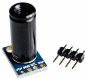
Рисунок 6. Інфрачервоний датчик температури MLX90614ESF-DCI
