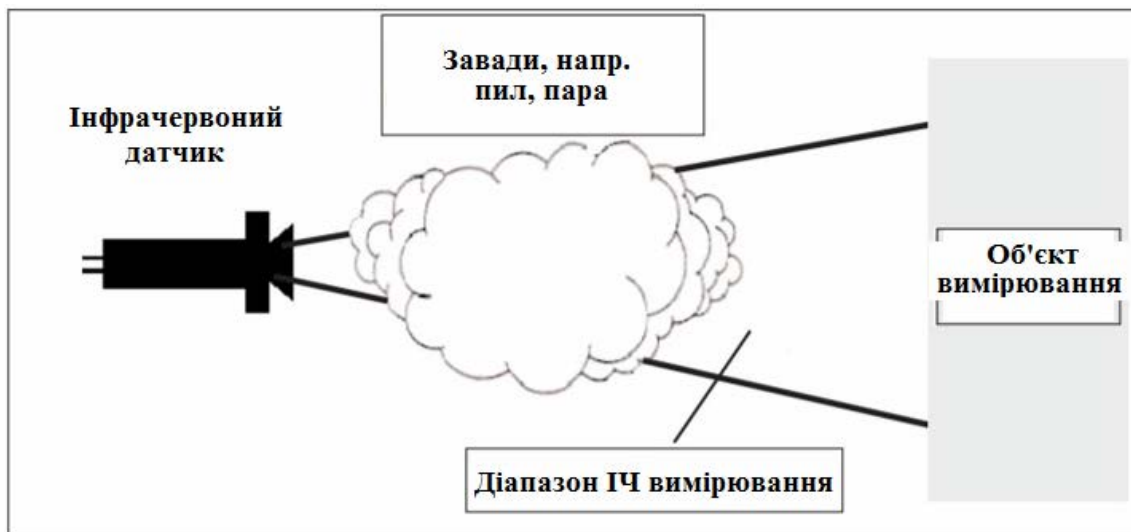
Рисунок 4. Вимірювання через перешкоди
