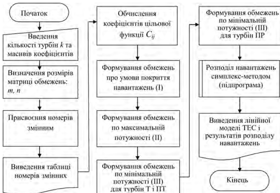
Рис. 1. Блок-схема алгоритму побудови лінійної математичної моделі ТЕС і розподілу навантажень між турбінами (розробка автора)
