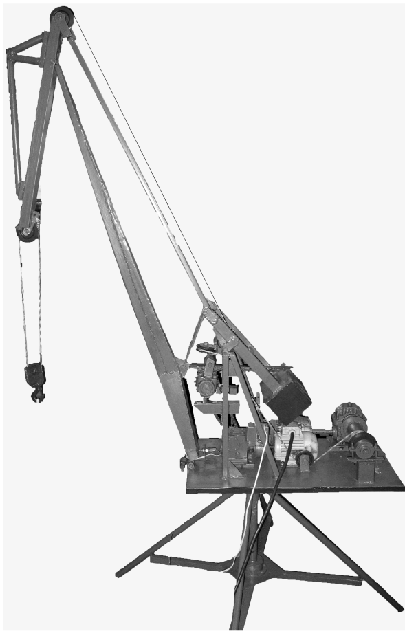
Рис.3. Загальний вигляд фізичної моделі стрілової системи крана
