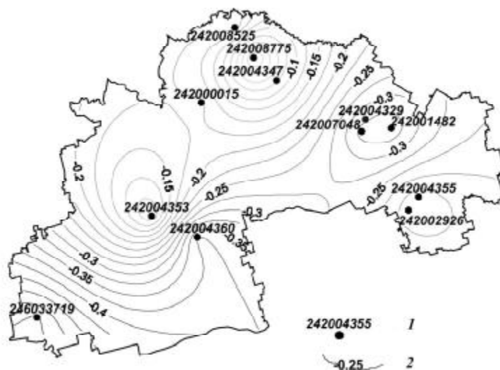
Рис. 4. Схема характеру розподілу тісноти кореляційних зв'язків режиму коливань рівнів ґрунтових вод із сонячною активністю, вираженою в числах Вольфа, на території досліджень: 1 – спостережні свердловини; 2 – ізокореляти
