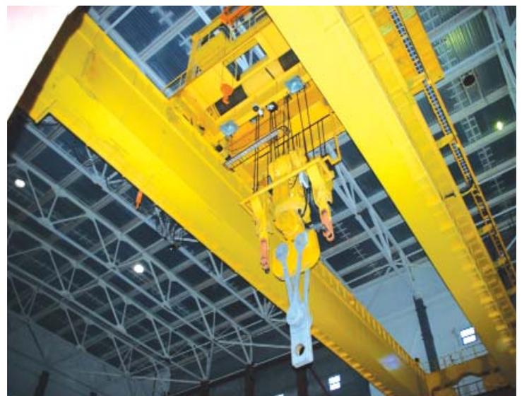
Мостовой кран г.п. 180 + 2×70 т Запорожская АЭС
