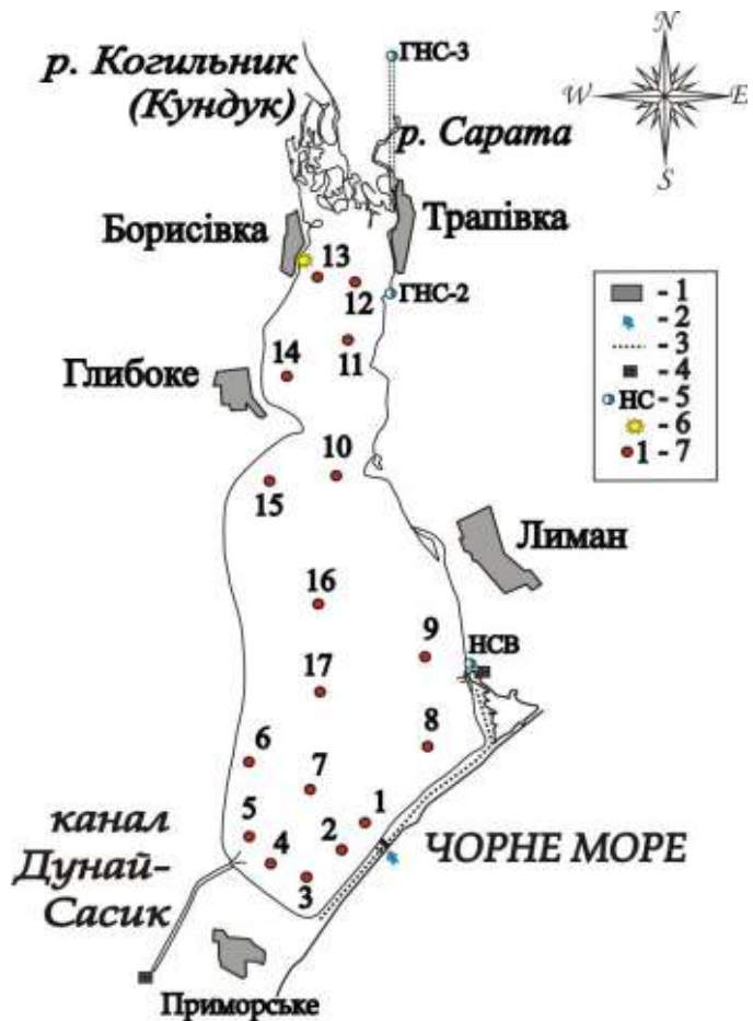
Рис. 1. Схема водосховища Сасик: 1 – населений пункт; 2 – місце існування Кундуцької прорви; 3 – дамба; 4 – шлюз; 5 – насосні станції (НСВ, ГНС-2, ГНС-3); 6 – водомірний пост ДГМО; 7 – станції досліджень в 2013-2014 рр.
