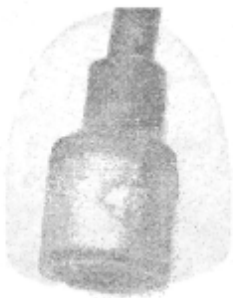
Рис. 1. Вимірювальний гідрофон на основі п'єзокераміки.
