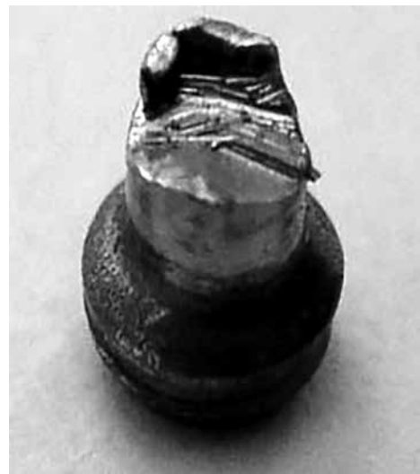
Рисунок 5 — Руїнування шийки штока від утоми
