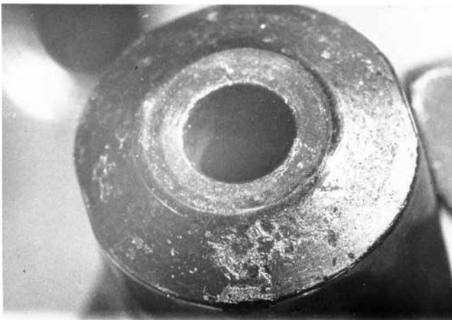
Рисунок 4. Пошкодження верхньої торцевої поверхні повзуна (якоря)
