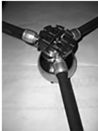
Рисунок 4 — Схема (а) та конструктивна реалізація (б) системи приводів із шланговими пневмодвигунами, яка призначена для переміщення виконавчого органа сферичною поверхню
