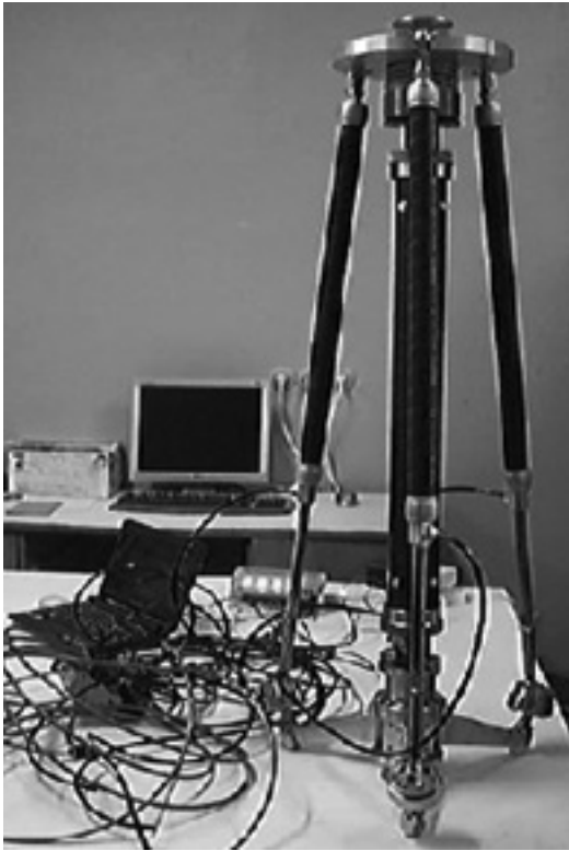
Рисунок 19 — Розроблений дослідний зразок просторової системи приводів із шланговими пневмодвигунами
