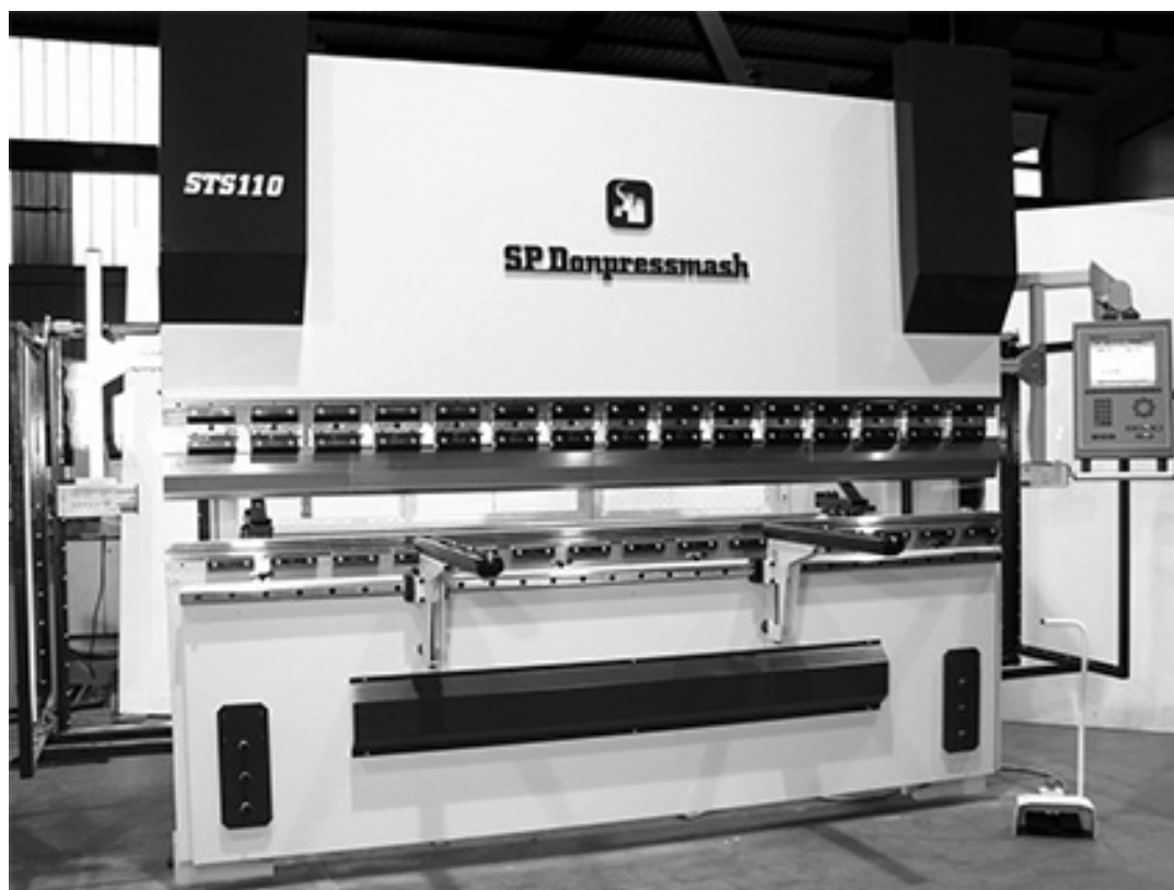
Рисунок 6 — Общий вид листогибочного преса SP Donpressmash (Россія—Германія)
