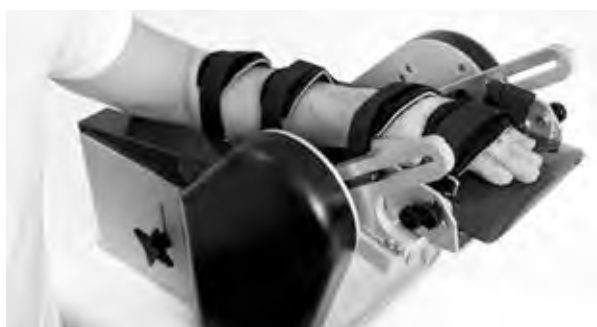
Рисунок 1 Прилад Нейрофлексор для вимірювання компонентів тону м'язів
