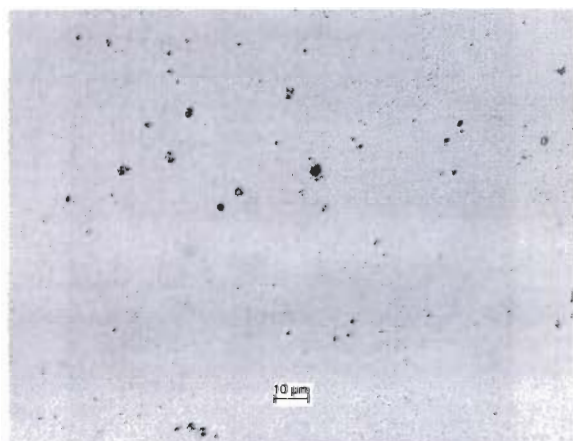
Рис. 6. Микроскопическое изображение поверхности покрытия CrAlN, синтезированного из источника фильтрованной плазмы с катодом \text{Cr}_{0,5}\text{Al}_{0,5} , изготовленным методом порошковой металлургии
