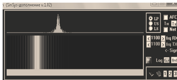
Рис.1. Аналіз частоти інформаційного сигналу від перетворювача «температура-частота»
