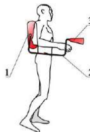
Рис.3. Носимий засіб пожежогасіння: 1 – балон із вогнегасною речовиною та із стисненим повітрям; 2 – кронштейн; 3 – форсунки
