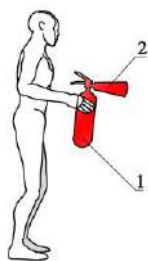
Рис.1. Переносний засіб пожежогасіння: 1 – балон із вогнегасною речовиною; 2 – розпилювач
