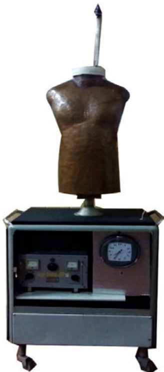
Рисунок 1 – Зовнішній вигляд (фото) імітаційного теплового стенду торсу людини (ІТСТЛ).
