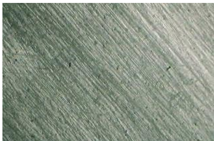
Рис. 4. Поверхня тертя зразка зі сталі 45 по ЛС59-1 в середовищі мастила I20-A в положенні зразка на полюсі S при навантаженні P=1 МПа та швидкості V=0,1 м/с
