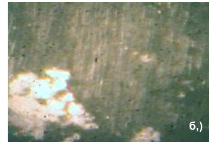
Рис. 1. Конгломерати продуктів зношування, що потрапили в зону тертя: а — латунний зразок, б — сталевий зразок (125°)
