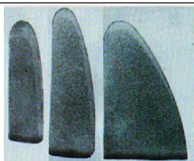
Рис. 9. Макроструктура вхідних кромок лопатки (в різних перетинах) після загартування СВЧ
