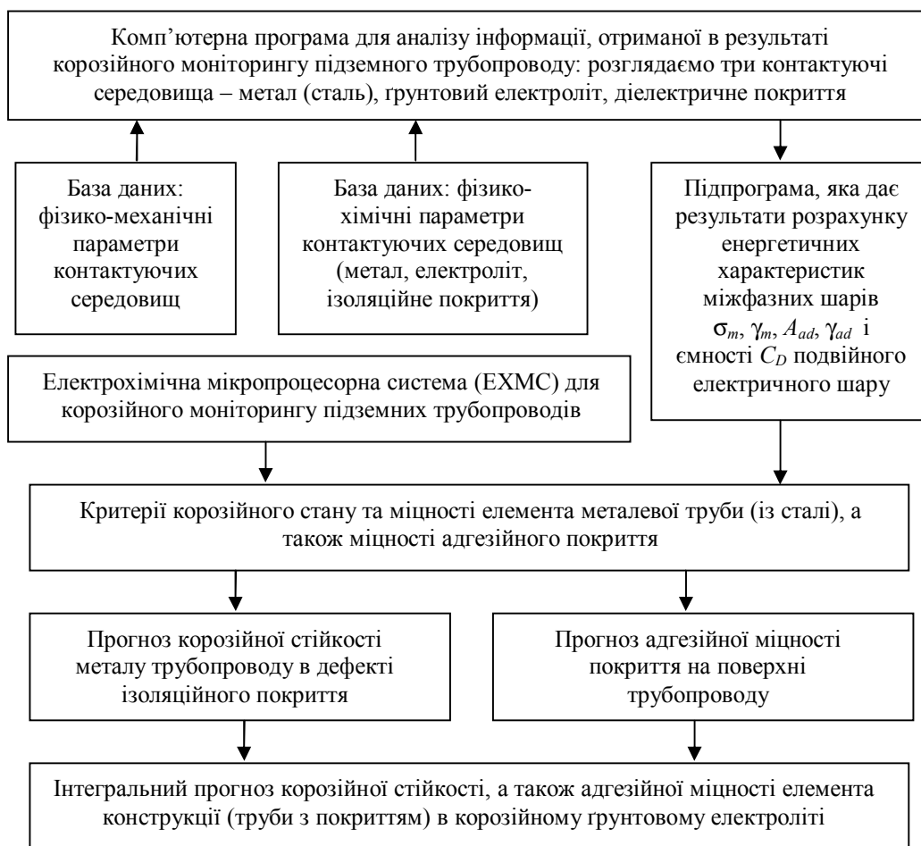
Блок-схема комп'ютерної програми для аналізу інформації, отриманої в результаті корозійного моніторингу підземного трубопроводу ( S_m – міжфазний натяг, g_m – міжфазна енергія, A_{ad} – робота адгезії, g_{ad} – енергія адгезійних зв'язків)
