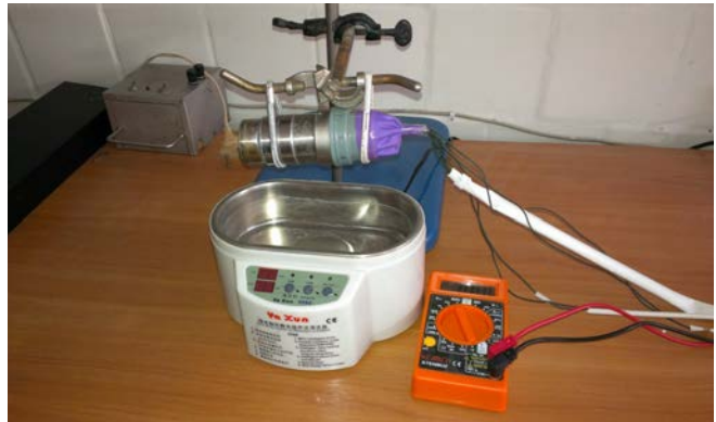
Рис. 2. Испытательный стенд: а) внешний вид; б) генератор плоской волны ультразвукового излучения
