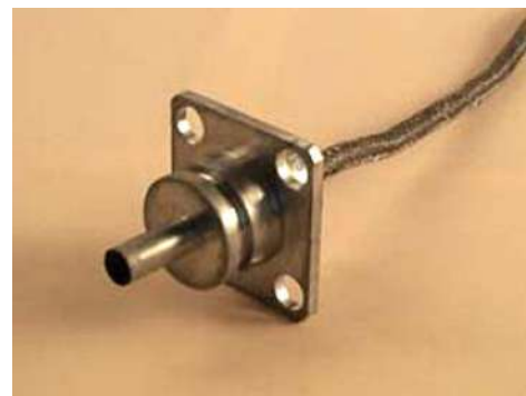
Рис. 4. Конструктивна схема та фото приймача теплового потоку ФОА 013-01
