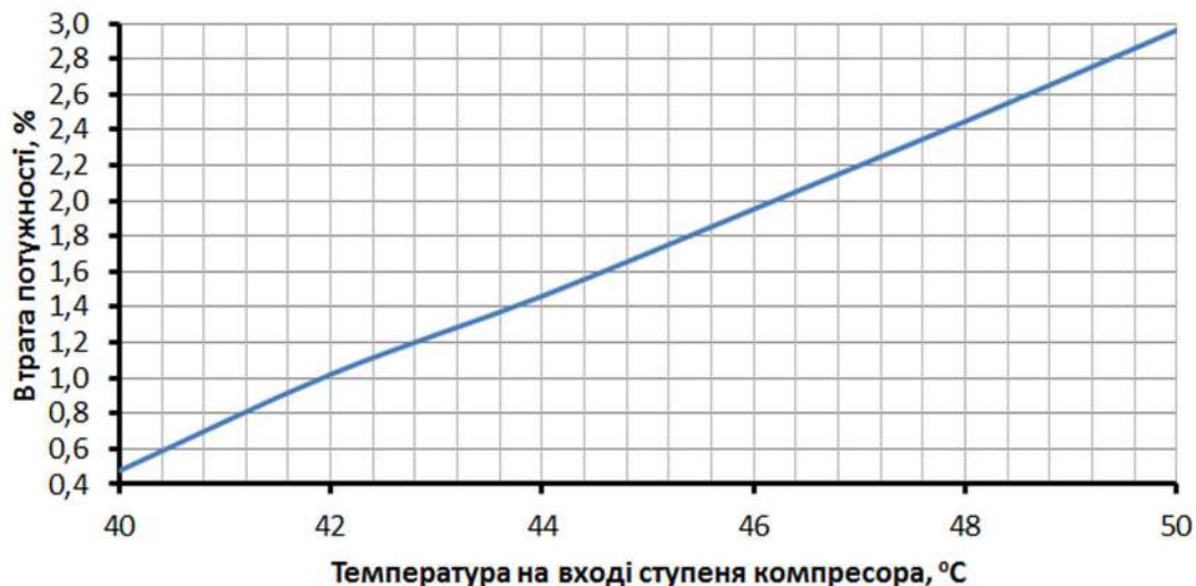
Рис. 3. Втрата потужності КУ від температури газу на вході
