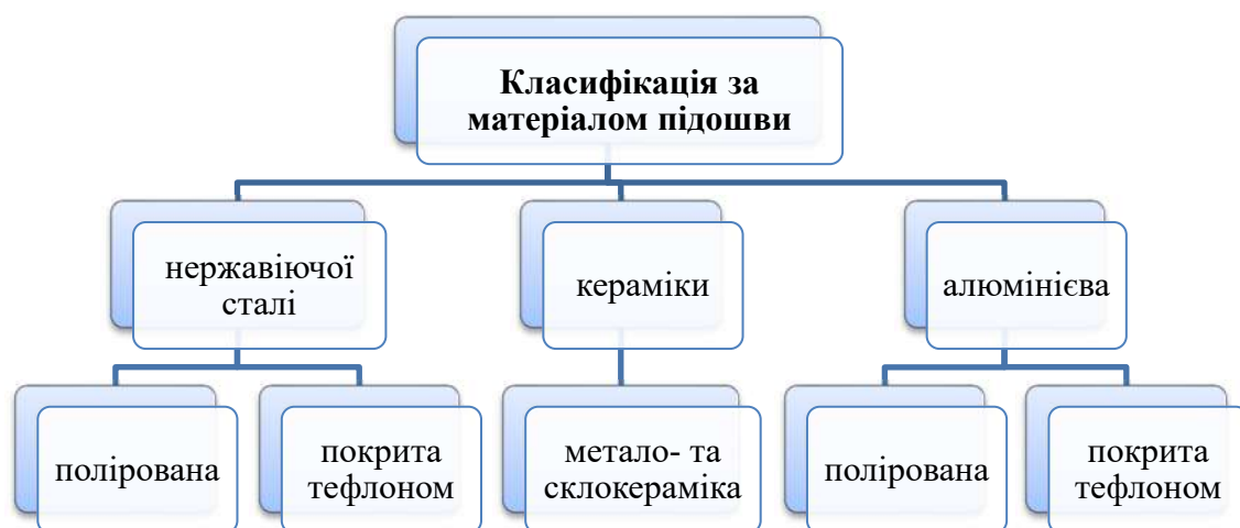
Рис. 1. Схема класифікації побутових прасок за матеріалом підшви
