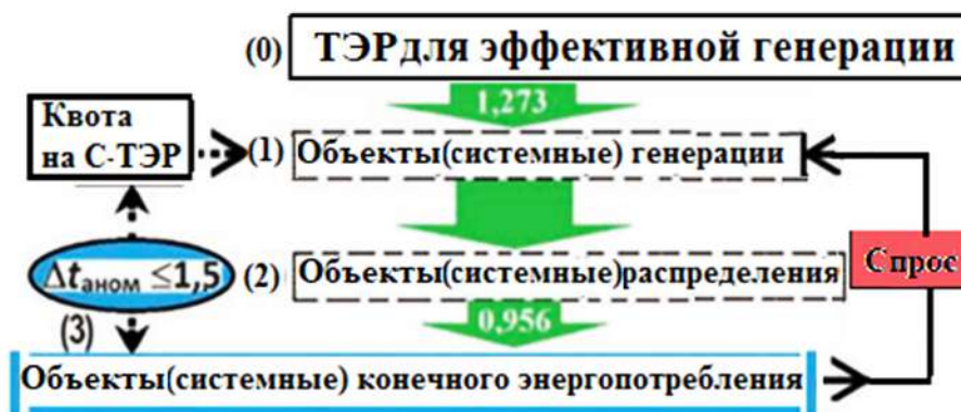
Рис. 1. Схема технологической цепи эффективных генерации, распределения и конечного потребления энергии с учетом ограничения (климатической квоты) на использование С-ТЭР и гранично допустимого отклонения \Delta t_{аном} аномальной глобальной температуры от допустимого ее значения. Стрелки указывают основные потоки энергии (числа, Гт у.т. — плановые к 2030 году показатели ТЭР и конечной энергии потребления в соответствии с 4ЭП ЕС) и управляющей информации
