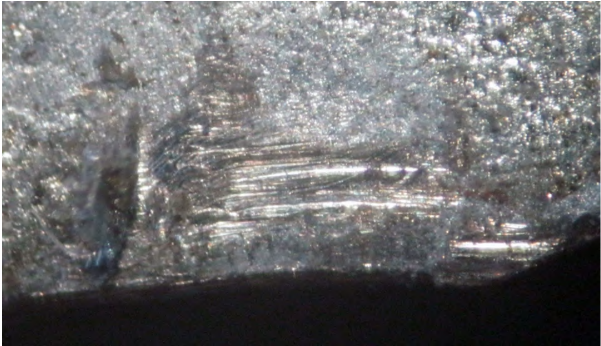
Рис. 10. Сліди від дії стороннього предмету на внутрішніх поверхнях врізного сувальдного замку, наданого на дослідження
