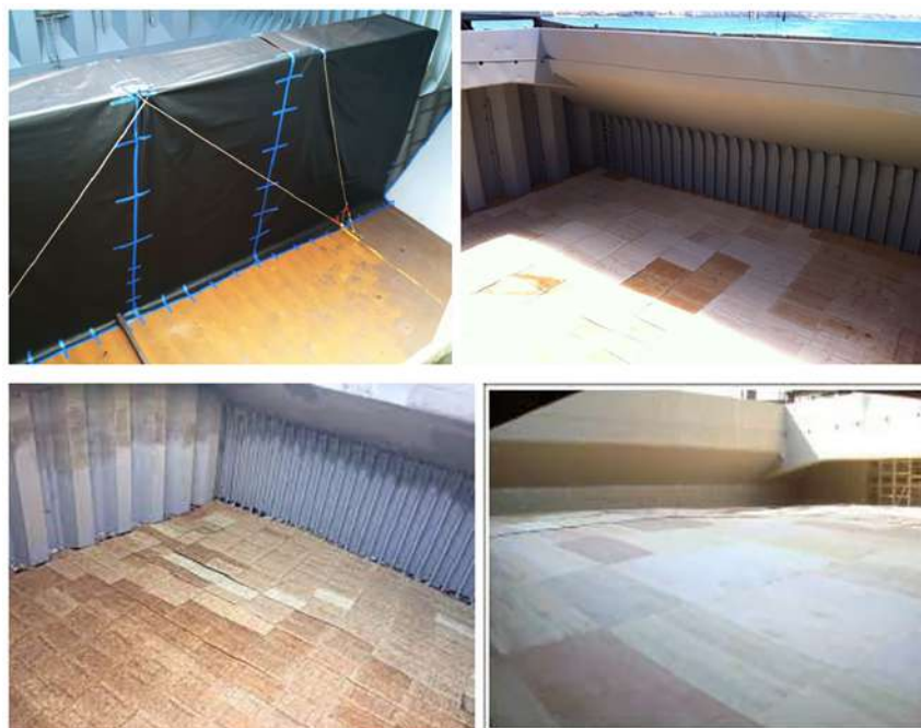
Рис. 3. Сепарація вантажів у трюмах судна
