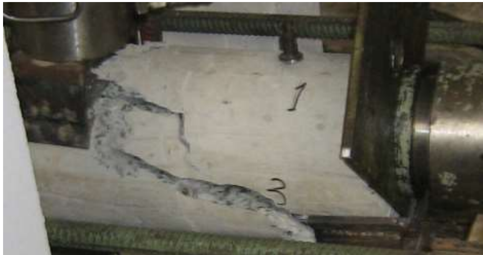
Рис. 2. Руйнування колони з попередніми ожатиєм по похилому перерізу.
