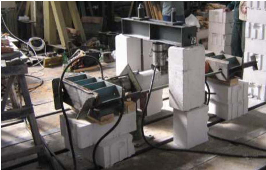
Рис. 1. Установа для проведення випробувань колон з попередніми обтисненням.
