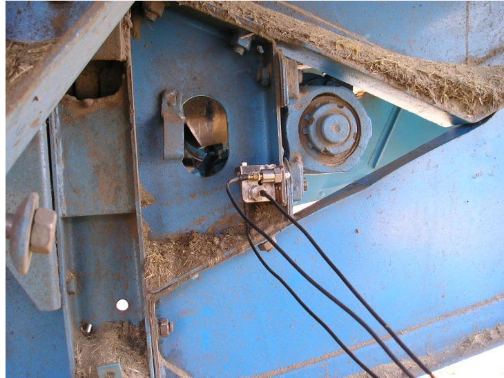
Рис. 1. Вимірювання вібрації різьбового з'єднання техніки.
