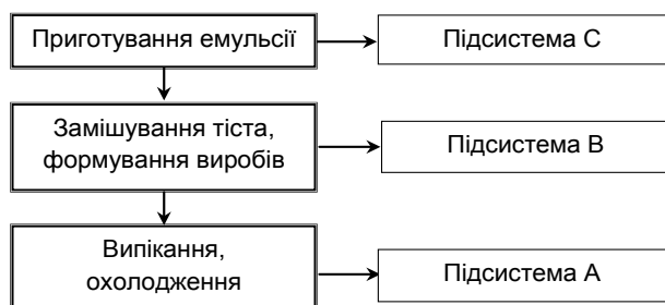
Рис. Декомпозиція технології пісочного напівфабрикату
