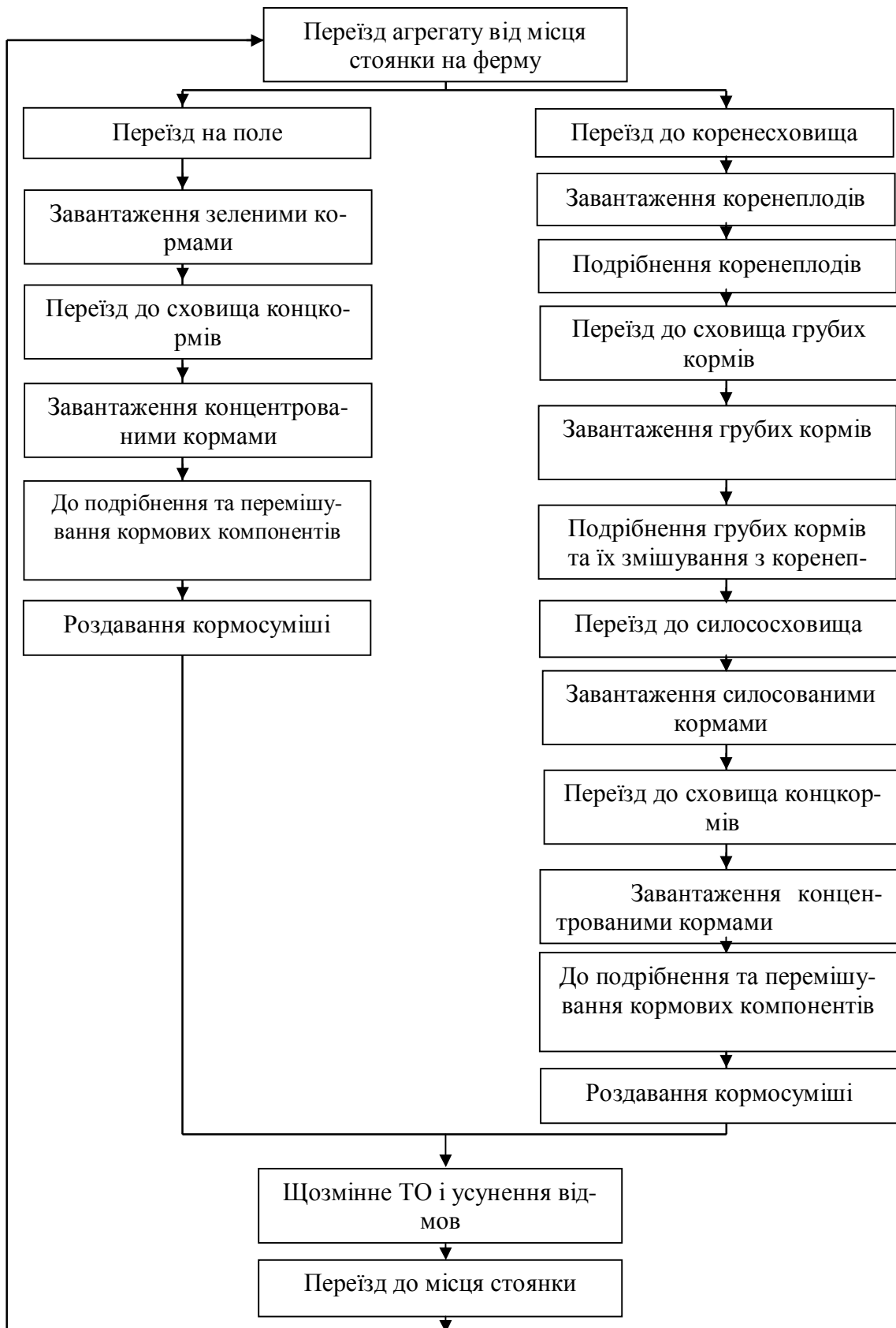
Рис. 1. Принципова схема приготування та роздавання кормових сумішей змішувачем-кормороздавачем.
